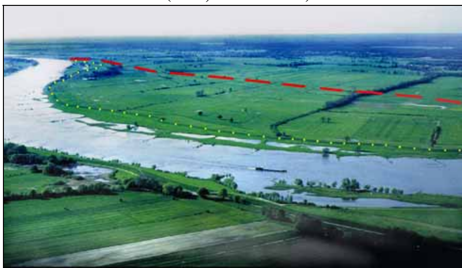
Obr. 47 Projekt odsazení ochranné hráze na Labi u Lenzenu (SRN, Braniborsko)
