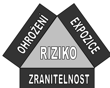
Obr. 18 Povodňové riziko jako model tří hlavních složek – „ohrožení“, „zranitelnost“ a „expozice“
